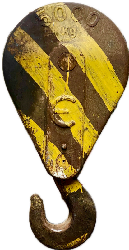
Zebrures jaunes peintes sur le treuil suspendu, afin de réduire les risques de heurt (Důl Mayrau)
